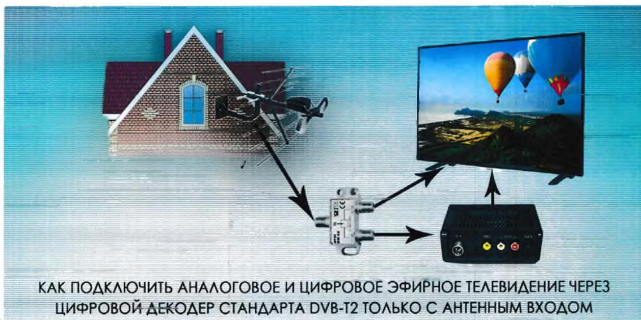
В этом случае кабель от антенны необходимо завести в антенный вход сплиттера. Отдельный антенный кабель выводим из антенного выхода сплиттера и подключаем к приставке, другой отдельный антенный кабель выводим из антенного выхода сплиттера и подключаем к телевизору.
